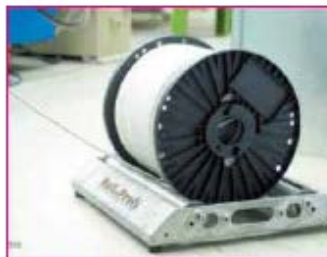
Abbildung 34: Falsche Richtung des Abrollers
